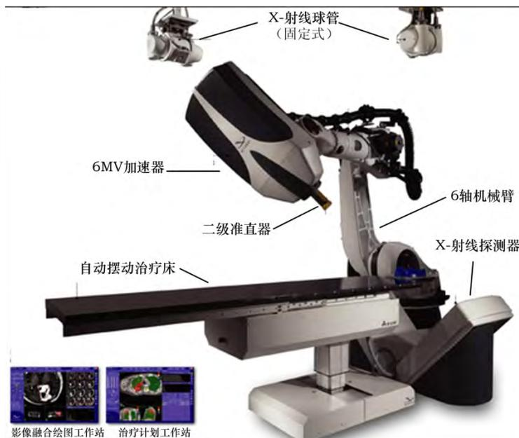
图 2-7 射波刀结构示意图
